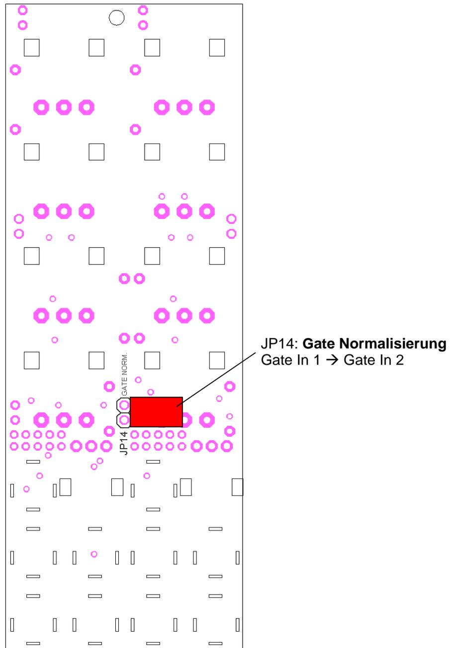
JP14 ist eine liegende Steckbrücke und dient der Normalisierung der Gate-Eingänge. Sie befindet sich auf der unteren Leiterplatte (Board B). Um diese Steckbrücke zu Entfernen oder zu Installieren ist ein geeignetes Werkzeug erforderlich (z.B. eine sehr kleine, lange Zange), da sich die Steckbrücke zwischen den beiden Leiterplatten befindet.
